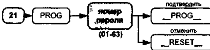
Малюнок 13. Граф-схема програми № 21 "Видалити пароль"
